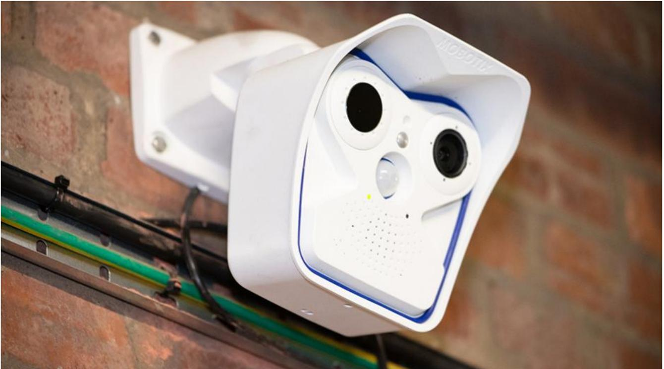
Die ONVIF-kompatiblen MOBOTIX-Kameras sind mit einer leistungsstarken CPU ausgestattet, die bis zu drei Videostreams gleichzeitig bereitstellen kann und den H.264/ONVIF-Standard erfüllt. Dadurch können die Kameras leicht mit anderen Systemen kombiniert werden, um einzigartige Lösungen für reale Probleme zu schaffen.
