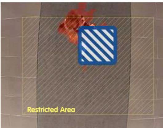
**"Gesperrter Bereich" (Restricted Area):** Ab Kamera-Firmware MX-V4.4.0.31 kann auch ein Ereignis ausgelöst werden, wenn ein im Bild "digital abgesteckter", rechteckiger Sperrbereich betreten wird. Über das Anlegen mehrerer Profile können bis zu 20 verschiedene Sperrbereiche pro Kamera gleichzeitig aktiviert werden. Aktive Sperrbereiche können im Bild mit der gewünschten Farbe und Transparenz sichtbar gemacht oder auch ausgeblendet werden.
