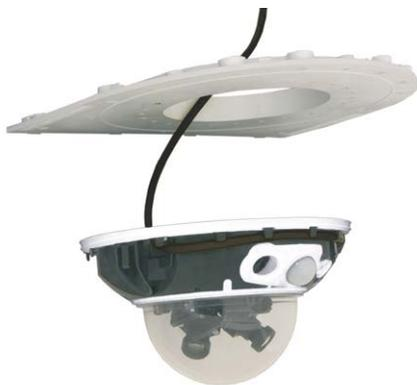
2. Richten Sie die Kamera so auf der Unterseite der Abdeckplatte aus, dass der PIR-Sensor in die vorgesehene Richtung zeigt und das Loch für die Inbusschraube rechts neben dem PIR-Sensor mit einem Loch der Abdeckplatte übereinstimmt.
