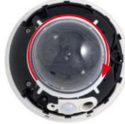
10. **Gehäusering montieren:** Positionieren Sie den Gehäusering so, dass die Aussparung im Ring (runde Öffnung) mit dem PIR-Sensor der Kamera übereinstimmt. Durch leichten Druck rastet der Ring in die drei vorgesehenen Halterungen im Gehäusesockel ein. **Alte Gehäuseringe (D10D, D12D) dürfen nicht mehr verwendet werden!**
