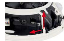
5. **USB-Kabel einführen:** Führen Sie das MOBOTIX USB-Kabel durch den Kabeldurchlass (siehe Abbildung) von unten ein und legen Sie es innerhalb der Kabelführung um die Kamera herum.
