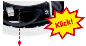
5. **Einsetzen der MicroSD-Karte:** Schieben Sie die MicroSD-Karte wie gezeigt (Kontakte in Richtung der Kuppel) mit einer Pinzette in den Karteneinschub. Stellen Sie sicher, dass beim Einschieben ein **Klicken** zu hören ist. Die Karte ist jetzt verriegelt und kann verwendet werden. **Beim Verwenden einer neuen MicroSD-Karte muss diese zuerst formatiert werden** (siehe Kapitel 3, «Inbetriebnahme der Kamera»).
