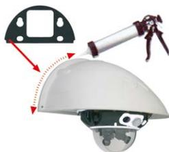
3. Die rechteckige Aussparung auf der Rückseite des Wandhalters ist für die installierte Unterputz-Anschlussdose oder eine MOBOTIX Interface-Box vorgesehen.
