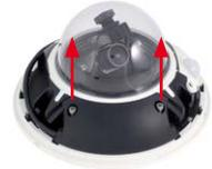
3. **Kabelabdeckung entfernen:** Wenn dies mit der Hand nicht gelingt, drücken Sie ein geeignetes Werkzeug (Schraubendreher) in die dafür vorgesehenen Vertiefungen (rote Pfeile). Hebeln Sie die Abdeckung vorsichtig nach oben in Richtung der Kuppel heraus.
