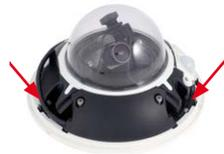
11. **Gehäusering montieren:** Positionieren Sie den Gehäusering so, dass die Aussparung im Ring (runde Öffnung) mit dem PIR-Sensor der Kamera übereinstimmt. Durch leichten Druck rastet der Ring in den drei vorgesehenen Halterungen im Gehäusesockel ein. **Alte Gehäuseringe (D10D, D12D) dürfen nicht mehr verwendet werden!**
