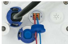
Zum Entnehmen einer Ader entriegeln Sie die entsprechende Seite der Anschlussbuchse, indem Sie mit einem kleinen Schraubendreher auf die orangefarbene Fläche drücken und dann die Ader herausziehen.
