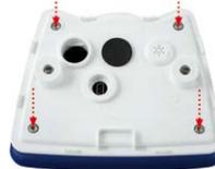
3. **Rückseite festschrauben und Anschlusskabel wieder anbringen:** Setzen Sie die vier Inbusschrauben der Rückseite wieder ein und ziehen Sie diese mit dem mitgelieferten 2,5 mm-Inbusschlüssel fest. Nun müssen die vorher gelösten Kabel wieder angeschlossen werden (siehe *Abschnitt 2.7.6* und *Abschnitt 2.7.7*).
