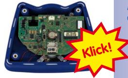
2. **Rückseite aufsetzen:** Die Rückseite des Kameragehäuses wieder aufsetzen und dabei darauf achten, dass die Schraubenlöcher für die Rückseite über den Gewindeeinsätzen liegen.
