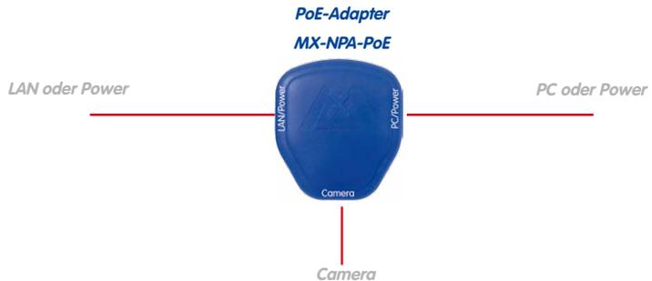
Die **maximale Kabellänge** für die Spannungsversorgung über das Ethernet-Kabel beträgt **100 m**. Zur Reichweitenverlängerung der Ethernetverbindung auf bis zu 500 m kann das als Zubehör erhältliche Mx2wire+ Mediakonverter-Set eingesetzt werden (maximale Übertragungsleistung bei 500 m Leitungslänge: 45 Mbit/s und 12 W für PoE-Gerät).
