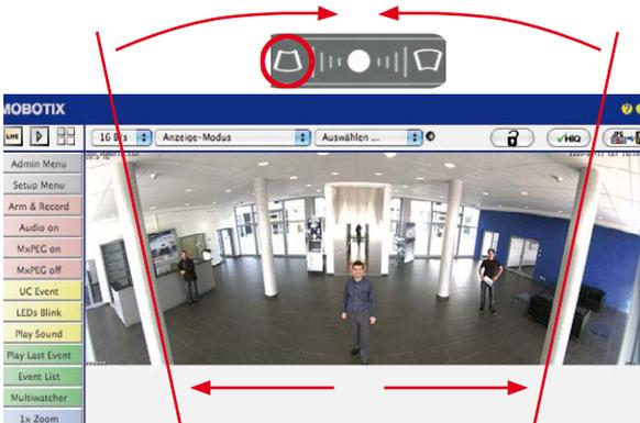
Je nach eingestellter Montageart (Decke, Wand, Boden) stehen Panoramakorrektur und Korrektur der Bildverdrehung nicht zur Verfügung!
