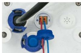
Zum Entnehmen einer Ader entriegeln Sie die entsprechende Seite der Anschlussbuchse, indem Sie mit einem kleinen Schraubendreher auf die orangefarbene Fläche drücken und dann die Ader herausziehen.
