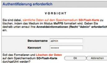
Die Karte wird nun von der MOBOTIX-Kamera formatiert. Für eine 8 GB MicroSD-Karte werden bei deaktivierter Option **Sicheres Löschen – langsam** bis 12 Minuten benötigt. Ist **Sicheres Löschen – langsam** aktiviert, kann dies 3 bis 14 Stunden dauern.
