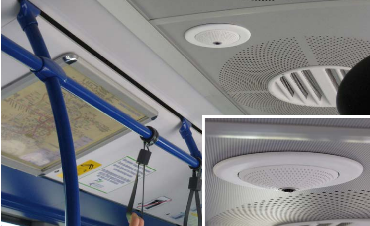
Q25M im Deckeneinbau-Set (Nahverkehrsbus)
