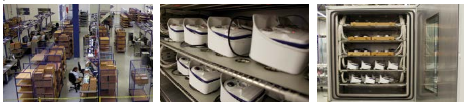
Chaque caméra est testée à des températures extrêmes avant sa distribution.
