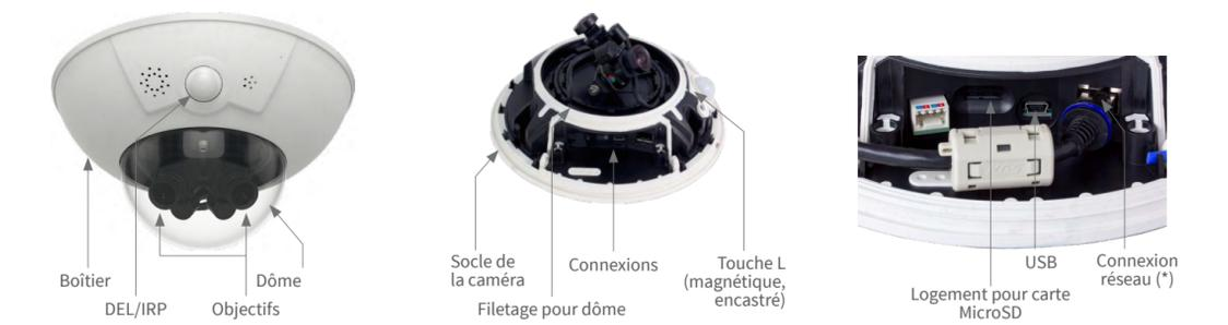
\* Pour supprimer les interférences électromagnétiques, fixez le ferrite pliable joint (1.7) directement derrière le connecteur RJ45 du câble réseau de la caméra, voir illustration.
