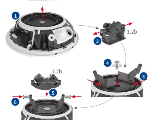
Insérez les deux supports du porte-objectif dans les glissières du socle **3**. Revissez légèrement la vis de maintien et la rondelle pour fixer les supports **4**.
