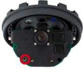
Die LED blinkt jetzt ein Mal und wiederholt dieses Blinksignal nach einer Pause von einer Sekunde (die Anzahl der Blinksignale entspricht der aktuell auswählbaren Boot-Option). Drücken Sie die Taste R erneut kurz (< 1 s), um zur nächsten Boot-Option zu wechseln. Nach der letzten Boot-Option wird wieder die erste angezeigt (1 x blinken).
