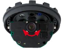
Ist die Bildscharfe korrekt eingestellt, deaktivieren Sie die Scharfstellhilfe wieder (Quick Control **Scharfstellhilfe**, Wert **Deaktiviert**).
