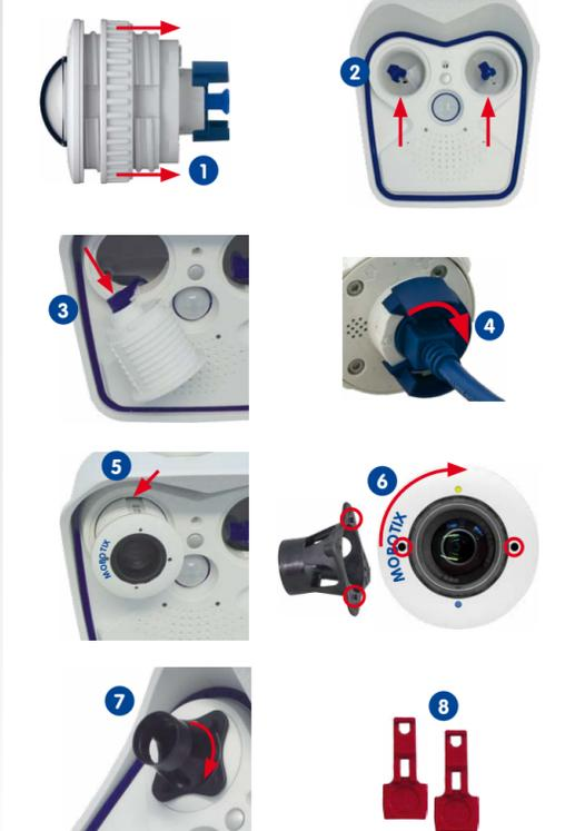
Öffnen/Schließen des Kameragehäuses
