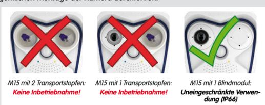
Einsetzen der Sensormodule
