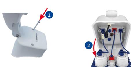
Drücken Sie **vorsichtig** von hinten mit dem Inbusschlüssel **abwechselnd** auf die rechte und linke Halteschraube **1** und schieben Sie das Frontelement nach vorne aus dem Gehäuse heraus.
