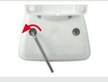
2. Kamera aus Wetterschutzgehäuse lösen
