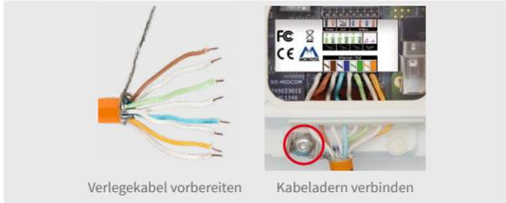
**Hinweis:** Zum Entnehmen einer Ader entriegeln Sie die Anschlussbuchse, indem Sie mit dem mitgelieferten Schraubendreher in den darüberliegenden Steckplatz drücken und dann die Ader herausziehen.
