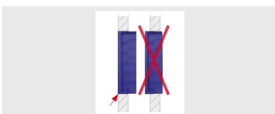
Um ein Verschmutzen des Gehäuseinnenraums bei der Montage zu verhindern, den mitgelieferten Schutzkarton vor dem Wandeinbau in das Unterputzgehäuse einsetzen. Nach dem Einputzen des Gehäuses kann
