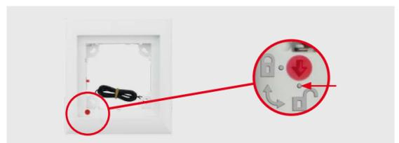
**Achtung:** Bei Installationen, in denen ein Diebstahlschutz nicht erforderlich ist, wie z. B. bei einer Innenmontage, aktivieren Sie die Diebstahlschutzsperre **nicht** (roter Drehknopf bleibt auf dem Symbol „offenes Schloss“). Falls Sie den Drehknopf aus Versehen verdrehen sollten, muss gewährleistet sein, dass die Diebstahlschutzleitung an eine Batterie (9 V DC) angeschlossen werden kann! Ansonsten kann das Modul nicht mehr aus dem Rahmen gelöst werden.
