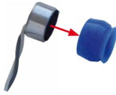
Führen Sie das Mikrofon in den Schacht auf der Rückseite des Kameragehäuses ein. Drücken Sie das Mikrofon mithilfe eines nicht-metallischen Stäbchens (Holz, Pappe, nicht-leitender Kunststoff) vorsichtig bis zum Anschlag in das Gehäuse.
