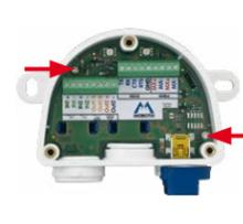
Schrauben Sie die Interface-Box-Platinen mit den gleichen Schrauben und dem Torxschlüssel an den entsprechenden Positionen im Gehäuse des Aufputz-Sets fest.
