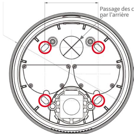
Faites passer les câbles par l'arrière (à travers le joint d'étanchéité du kit de montage visible) ou par le côté. En cas de passage par l'arrière, il est nécessaire d'ouvrir le passe-câble du joint d'étanchéité à l'aide d'un couteau aiguisé (croix rouge sur l'image de droite). Le trou à percer pour faire passer les câbles ne doit pas être plus grand que nécessaire.
