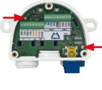
Fixez le boîtier d'interface avec les mêmes vis et la clef Torx dans les positions correspondantes dans le boîtier du kit de montage visible.
