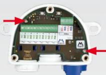
Fixez le boîtier d'interface avec les mêmes vis et la clef Torx dans les positions correspondantes dans le boîtier du kit de montage visible.
