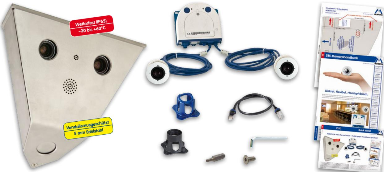
Vandalismusschutz IP Videokamera für Eckmontage im 3 mm-Edelstahlgehäuse; Frontplatte und Deckel aus 5 mm Edelstahl; automatische Tag-/Nachtumschaltung aktivierbar; Mikrofon und Lautsprecher eingebaut; sämtliche Anschlüsse des S15D-Kameramoduls verwendbar. Erhältlich mit beliebigen Objektivkombinationen (Tag-/Nacht) der Brennweiten L25, L38, L51, L76 und L160; ein Bildsensor kann wahlweise nach unten weisend bestellt werden.
