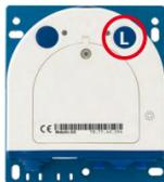
Die LED blinkt jetzt ein Mal und wiederholt dieses Blinksignal nach einer Pause von einer Sekunde (die Anzahl der Blinksignale entspricht der aktuell auswählbaren Boot-Option). Drücken Sie den Taster erneut kurz (< 1 s), um zur nächsten Boot-Option zu wechseln. Nach der letzten Boot-Option wird wieder die erste angezeigt (1 x blinken).
