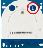
Maintenant, la LED clignote et répète ce signal après une pause d'une seconde (le nombre de signaux correspond à l'option de démarrage actuellement sélectionnable). Appuyez à nouveau brièvement sur la touche (< 1 s) pour passer à l'option de démarrage suivante. Après avoir passé la dernière option de démarrage, c'est la première qui s'affiche (1 clignotement).
