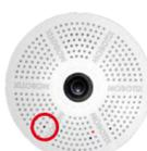
Die LED blinkt jetzt ein Mal und wiederholt dieses Blinksignal nach einer Pause von einer Sekunde (die Anzahl der Blinksignale entspricht der aktuell auswählbaren Boot-Option). Betätigen Sie den Taster erneut kurz (< 1 s), um zur nächsten Boot-Option zu wechseln. Nach der letzten Boot-Option wird wieder die erste angezeigt (1 x blinken).
