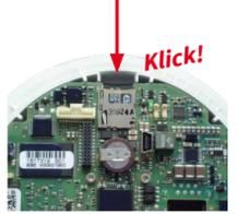
Setzen Sie die neue MicroSD-Karte ein und drücken Sie diese vorsichtig mit einem Finger in Pfeilrichtung, bis erneut ein **Klicken** zu hören ist.
