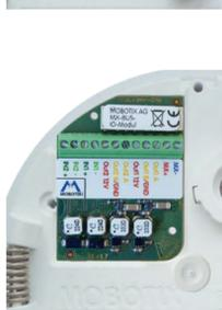
Achten Sie beim Anschließen der Verbindungsleitungen an das MxIOBoard-IC darauf, die Leitungen ohne Zug zur Platine zu führen (ggf. Zugentlastung durch Kabelbinder am Netzwerkabel herstellen).
