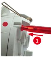
Drücken Sie anschließend leicht gegen den nächstgelegenen Federbügel, um die Rückwand etwas vom Gehäuse zu entfernen **2**.
