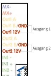
Darüber hinaus sind die Schaltein- und -ausgänge automatisch im Dialog **Admin Menu > Anschlüsse zuweisen** eingetragen und können direkt für Tür- und Lichtfunktionen genutzt werden.
