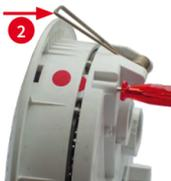
Wiederholen Sie den Vorgang für die beiden anderen Verriegelungen und nehmen Sie die Rückwand der Kamera ab.
