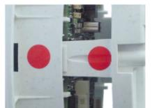
Stellen Sie sicher, dass die beiden anderen Rasthaken ebenfalls korrekt positioniert sind und drücken Sie die Rückwand gleichmäßig ins Gehäuse, bis alle drei Haken hörbar einrasten.
