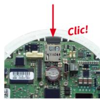
Installez la nouvelle carte MicroSD et appuyez dessus doucement avec le doigt dans le sens de la flèche, jusqu'à entendre de nouveau un **clac**.
