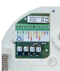
Lors du branchement des câbles de connexion au MxIOBoard-IC, veillez à les raccorder à la platine sans traction (si besoin, déchargez la traction en posant un attache-câbles sur le câble réseau).
