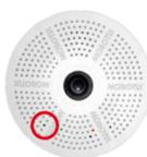
La DEL clignote une fois et répète le signal après une pause d'une seconde (la nombre des clignotements correspond à l'option de démarrage actuelle). Pressez brièvement avec le trombone (< 1 sec.) afin de basculer vers l'option de démarrage prochaine. Après la dernière option de démarrage dans le menu, la caméra recommencera avec la première option (un clignotement).
