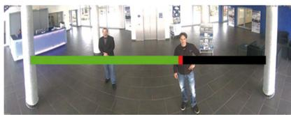
Drehen Sie das Objektiv mithilfe des roten Objektivschlüssels vorsichtig hin und her, bis der rote Bereich der Scharfstellhilfe möglichst vollständig verschwunden ist. Nehmen Sie den Objektivschlüssel nach jedem Ändern der Schärfereinstellung ab.
