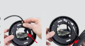
Nehmen Sie nun die Scheibe und biegen Sie sie am Einschnitt etwas auseinander. Legen Sie die Scheibe um die Kabel an der Stelle zwischen Dichtung und Gehäuse. Schieben Sie dann die Scheibe auf die Öffnung des Gehäuses.
