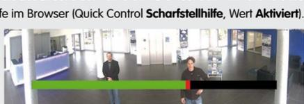
Drehen Sie das Objektiv mit dem roten Objektivschlüssel vorsichtig hin und her, bis der rote Bereich der Scharfstellhilfe möglichst vollständig verschwunden ist.
