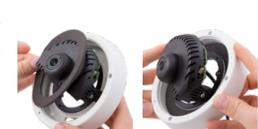
Nehmen Sie nun die Scheibe und biegen Sie am Einschnitt etwas auseinander. Legen Sie die Scheibe über den Ring in der Vertiefung des Gehäuses. Drehen Sie dann das Gehäuse auf die Rückseite.
