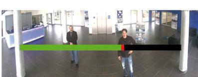
Drehen Sie das Objektiv mit dem roten Objektivschlüssel vorsichtig hin und her, bis der rote Bereich der im Kamerabild eingeblendeten Scharfstellhilfe möglichst vollständig verschwunden ist.
