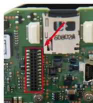
Drücken Sie die Platine des Moduls vorsichtig mit einem Finger auf den Steckplatz. Stellen Sie sicher, dass das MxIOBoard-IC vollständig eingesteckt ist.
