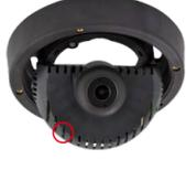
Die LED blinkt jetzt ein Mal und wiederholt dieses Blinksignal nach einer Pause von einer Sekunde (die Anzahl der Blinksignale entspricht der aktuell auswählbaren Boot-Option). Drücken Sie die Taste erneut kurz (< 1 s), um zur nächsten Boot-Option zu wechseln. Nach der letzten Boot-Option wird wieder die erste angezeigt (1 x blinken).
