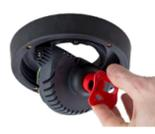
Après mise en service de la caméra, l'objectif doit encore être mis au point (voir « Mise en service de la v26 »).
