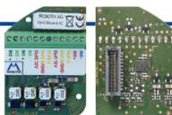
Enfoncez la platine du module dans son logement avec précaution avec votre doigt. Vérifiez que le MxIOBoard-IC est complètement enfoncé.
