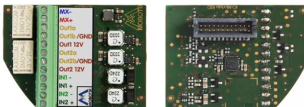
**Links:** Vorderseite des MX-Bus-IO-Moduls mit grüner Klemmleiste zum Anschluss externer Geräte: Die mit 12 Volt versorgten Anschlüsse Out1 und Out2 dienen beispielsweise zur Anbindung von Relais (z. B. Eltako ER12-002-UC).
