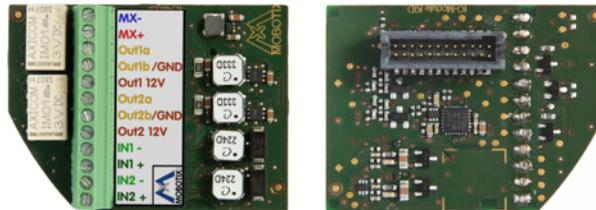
**Links:** Vorderseite des MX-Bus-IO-Moduls mit grüner Klemmleiste zum Anschluss externer Geräte: Die mit 12 Volt versorgten Anschlüsse Out1 und Out2 dienen beispielsweise zur Anbindung von Relais (z. B. Eitako ER12-002-UC).
