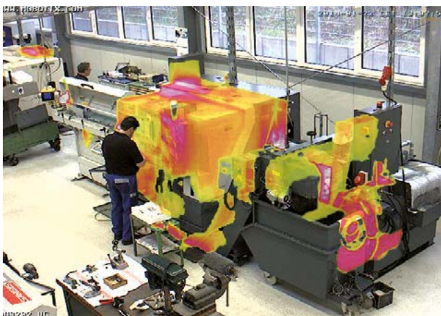
MOBOTIX Dual-Thermal cameras bieten Thermal Overlay, um sogenannte „Hotspots“ im sichtbaren Bild zu identifizieren und größere Schäden zu vermeiden.
