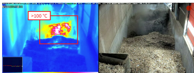
Radiométrie thermique (TR) : Alarme automatique si la température passe au-dessus ou en dessous des limites définies
