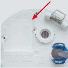
Faites glisser la platine du module dans son logement avec précaution. Fixez le module avec les deux vis cruciformes (flèches rouges sur l'illustration).
