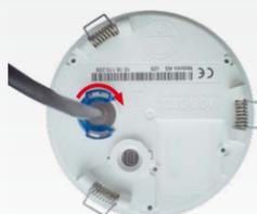
Pour finir, procédez à un contrôle de l'image et corrigez-la si besoin en pivotant avec précaution la caméra.
