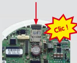
Installez la nouvelle carte MicroSD et appuyez dessus doucement avec le doigt dans le sens de la flèche, jusqu'à entendre de nouveau un **clac**.
