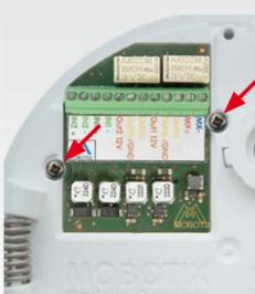
Lors du branchement des câbles de connexion au Module I/O MxBus, veillez à les raccorder à la platine sans traction (si besoin, déchargez la traction en posant un attache-câbles sur le câble réseau).
