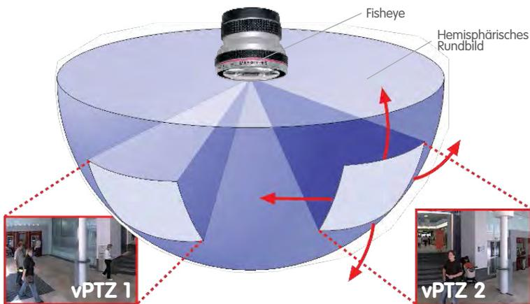
Die hemisphärische Kamera erfasst über ein sehr weitwinkliges Fisheye-Objektiv eine Halbkugel im Raum (Hemisphäre) und projiziert diese auf einen hochauflösenden Bildsensor. Von der Decke aus deckt so ein hemisphärischer (halbkugelförmiger) Bildbereich den kompletten Raum ab. In der Halbkugel ist das Bild besonders zu den Rändern
