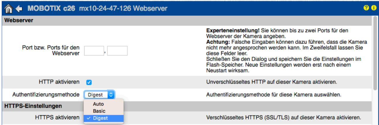
Diese HTTP-Authentifizierung ist eine anerkannte Methode, mit der sich der Nutzer eines Webbrowsers gegenüber dem Webserver (MOBOTIX Kamera) per Benutzername und Passwort authentifizieren kann. Bei der Digest Access Authentifizierung werden die Zugangsdaten nie im Klartext übermittelt und können so nicht „abgehört“ werden.
