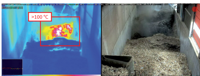
Radiometria termica (TR) Allarme automatico quando i valori della temperatura scendono al di sotto o superano determinati limiti o intervalli
