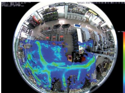
Registrazione originale di una telecamera Indoor c25 Hemispheric di MOBOTIX con visualizzazione della heatmap
