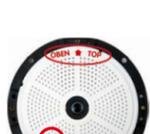
Die LED blinkt jetzt ein Mal und wiederholt dieses Blinksignal nach einer Sekunde (die Anzahl der Blinksignale entspricht der aktuell auswählbaren Boot-Option). Betätigen Sie den Taster erneut kurz (< 1 s), um zur nächsten Boot-Option zu wechseln. Nach der letzten Boot-Option wird wieder die erste angezeigt (1 x blinken).
