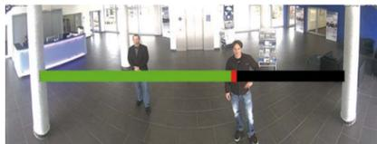
Faites pivoter doucement l'objectif d'un côté puis de l'autre avec la clé d'objectif (pos. 1.3), jusqu'à ce que la zone rouge de l'aide à la mise au point ait disparu autant que possible.
