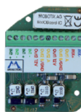
MxIOBoard-IC für Schaltein- /-ausgänge (Zubehör)
