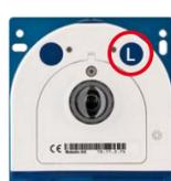
Die LED blinkt jetzt ein Mal und wiederholt dieses Blinksignal nach einer Pause von einer Sekunde (die Anzahl der Blinksignale entspricht der aktuell auswählbaren Boot-Option). Drücken Sie den Taster erneut kurz (< 1 s), um zur nächsten Boot-Option zu wechseln. Nach der letzten Boot-Option wird wieder die erste angezeigt (1 x blinken).
