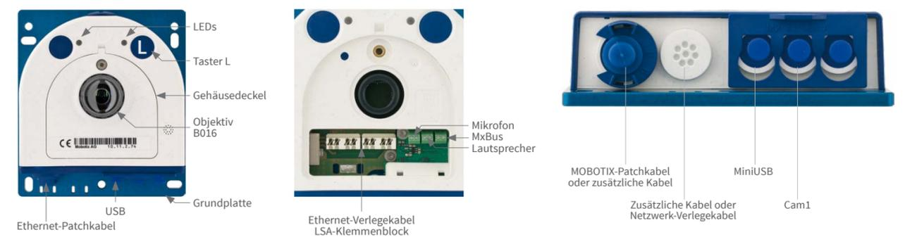
Für besondere Anwendungssituationen kann die S26 auch mit einem externen Sensormodul betrieben werden. In diesem Fall muss das externe Sensormodul mit dem Anschluss „Cam1“ verbunden werden und die Inbetriebnahme erfolgt wie bei einer S16. Nach Konfiguration des externen Sensormoduls wird der integrierte Bildsensor der S26 deaktiviert.
