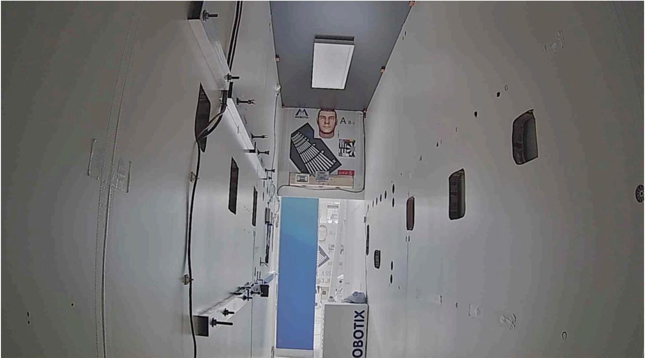
**Original MOBOTIX MOVE Kamerabild mit aktivierter WDR-Funktion:** Sowohl innerhalb des dunklen Testraums als auch an der geöffneten Tür mit starkem Lichteinfall sind Details gut erkennbar. Die Kamera fügt zwei innerhalb eines minimalen Zeitabstands unterschiedlich belichtete Einzelbilder automatisch zu einem Live-Gesamtbild zusammen.
