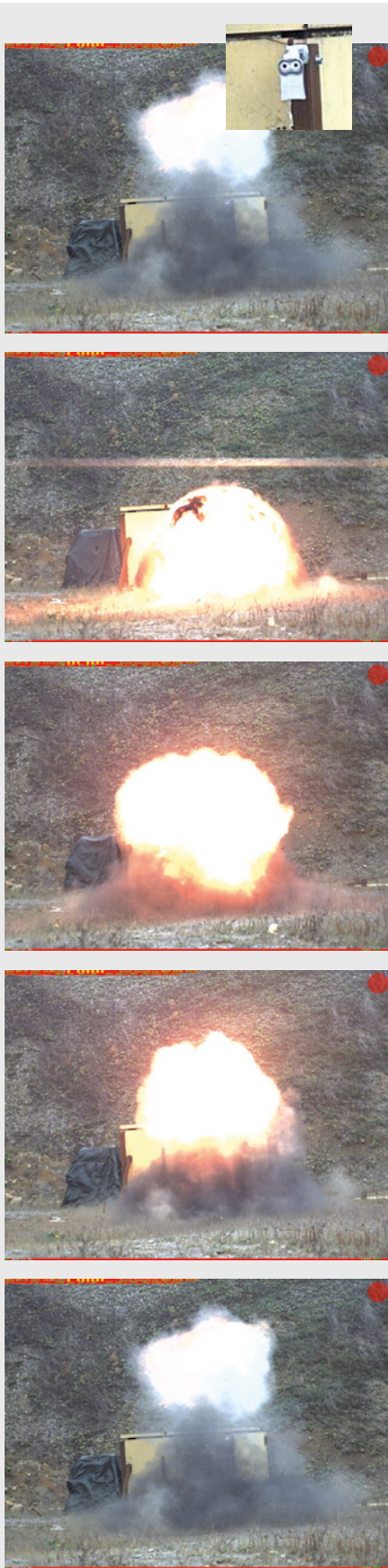
Durchführung eines Explosionstest mit 1 KG Nitropenta/Semtex aus 2 m Entfernung. Die MOBOTIX Kamera ist noch funktionstüchtig.
