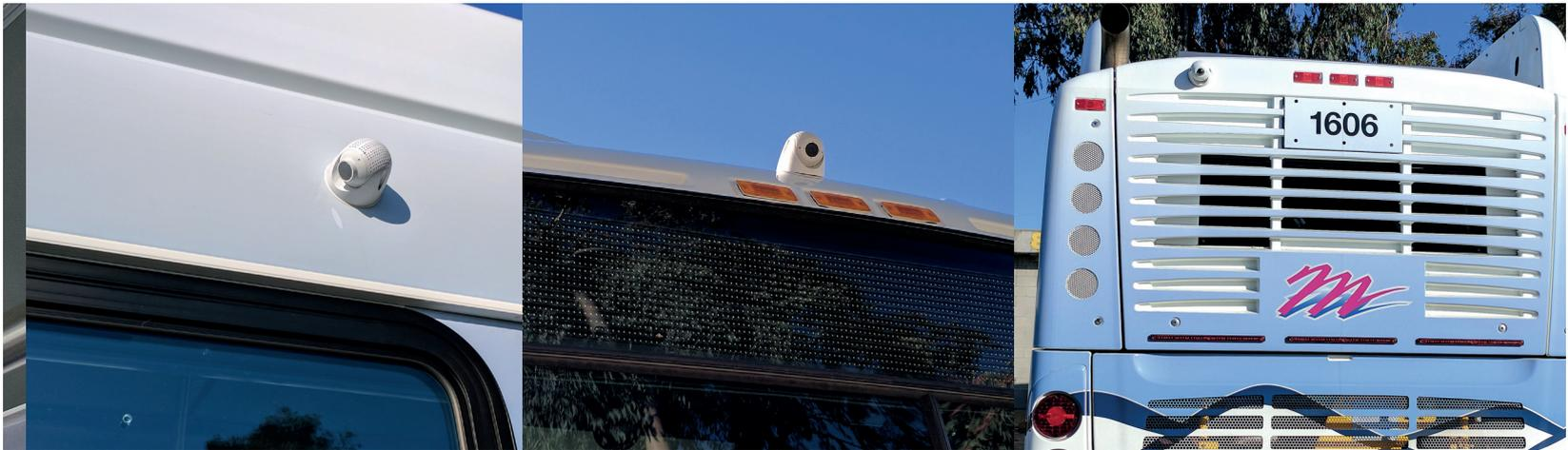
Los elementos MOBOTIX cuentan con la certificación EN 50155:2007, una norma internacional que abarca los equipos electrónicos utilizados en parques móviles y aplicaciones ferroviarias y que aporta parámetros de temperatura, humedad, impacto y vibración, entre otros. Además, una cámara IP MOBOTIX no requiere más de 4-5 watts y no cuenta con piezas mecánicas móviles, lo que aumenta considerablemente su fiabilidad.
