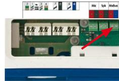
Die Klemmleiste hat zwei Anschlüsse, um ein MxBus-Modul anzuschließen (von dort aus können dann weitere MxBus-Module angeschlossen werden). Die Länge der gesamten MxBus-Leitung darf dabei 50 m nicht übersteigen.
