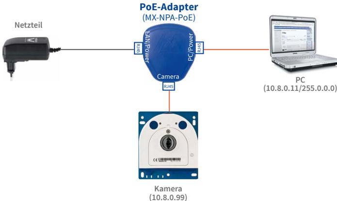
Bei Direktverbindung zum PC ersetzt der PoE-Adapter das Crossover-Kabel
