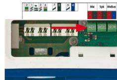
Auf der Klemmleiste kann ein externes Mikrofon (rote Box) und ein externer Lautsprecher (rote Box) mit den folgenden technischen Daten angeschlossen werden:
