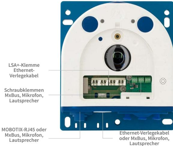
Bei Verwendung des Ethernet-Verlegekabels wird der Bajonettverschluss entfernt und der Stopfen des Ethernet-Patchkabels je nach verwendetem Kabel durch einen der zusätzlichen Stopfen (M.4/5) oder den Einzeladerstopfen (1.10) ersetzt.
