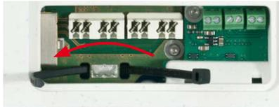
3. **Verlegekabel vorbereiten:** Verlegekabel ablängen, durch den weißen Einzeladerstopfen (5-7 mm) führen, 35 mm abisolieren und in die einzelnen, paarweise verdrehten Adern inkl. 15 mm Schirmung auftrennen. Schirmgeflecht in 10 mm Breite unten so um den Mantel wickeln, dass dieser später mit dem Kabelbinder auf der Kontaktfläche fixiert werden kann.
