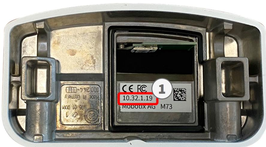
**Fig. 7: IP-Adresse der Kamera auf der Rückseite des Kameragehäuses**
