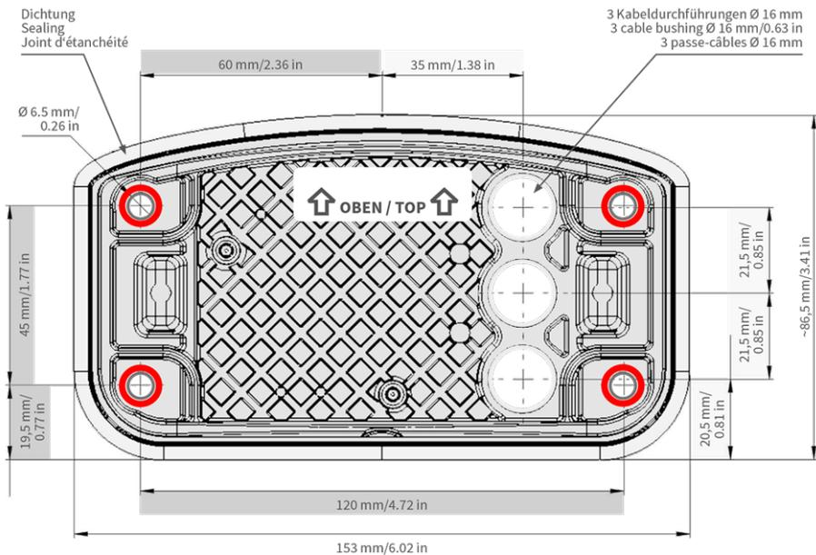
Fig. 15: Montageplatte mit markierten Bohrungen für Befestigungsschrauben
