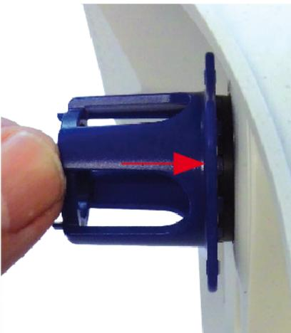
9. Drehen Sie das Objektivschutzglas mit dem blauen Objektivschlüssel bis zum Anschlag nach rechts, bis es einrastet.
