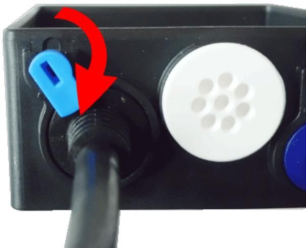
Fig. 21: Stecker des Netzwerkkabels in der Anschlussbox verriegeln
