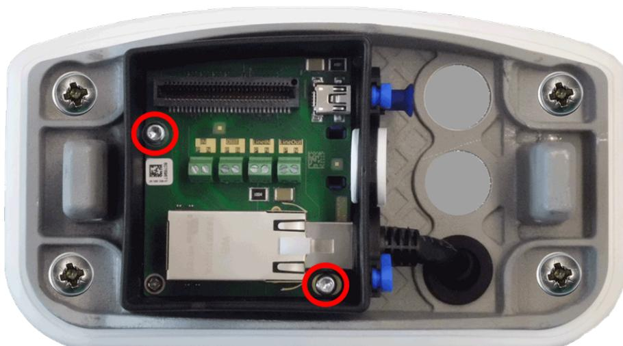
Fig. 23: Anschrauben der Anschlussbox (Draufsicht) mit zwei Befestigungsschrauben (in der Abbildung rot markiert) auf der Montageplatte.
