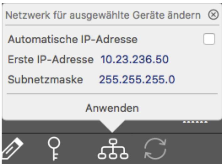
Fig. 30: Netzwerkeinstellungen für ausgewählte Geräte ändern
