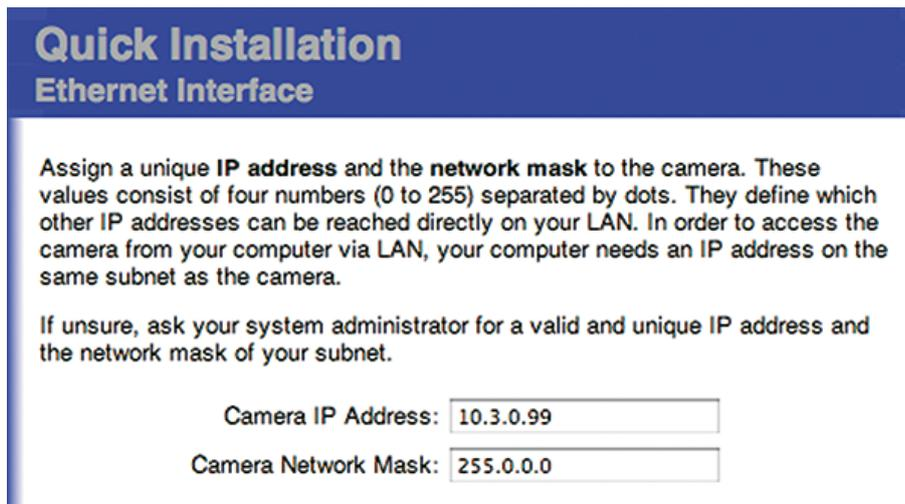
Fig. 28: Netzwerkeinstellungen in der Weboberfläche der Kamera
