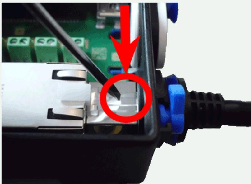
Fig. 22: Beim Entfernen des Netzwerksteckers aus der Anschlussbox Clip herunterdrücken!
