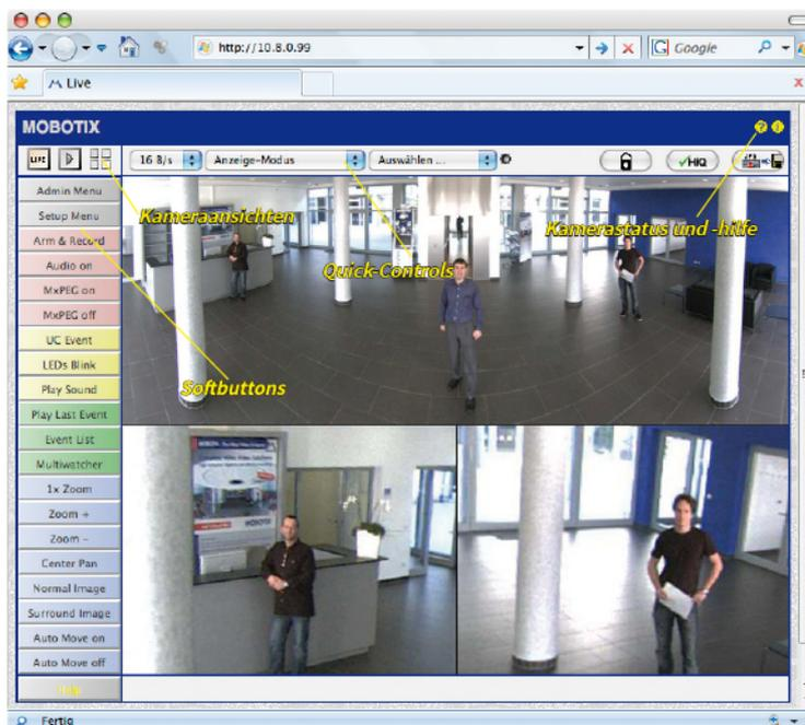
Fig. 31: Die Oberfläche der Kamerasoftware
