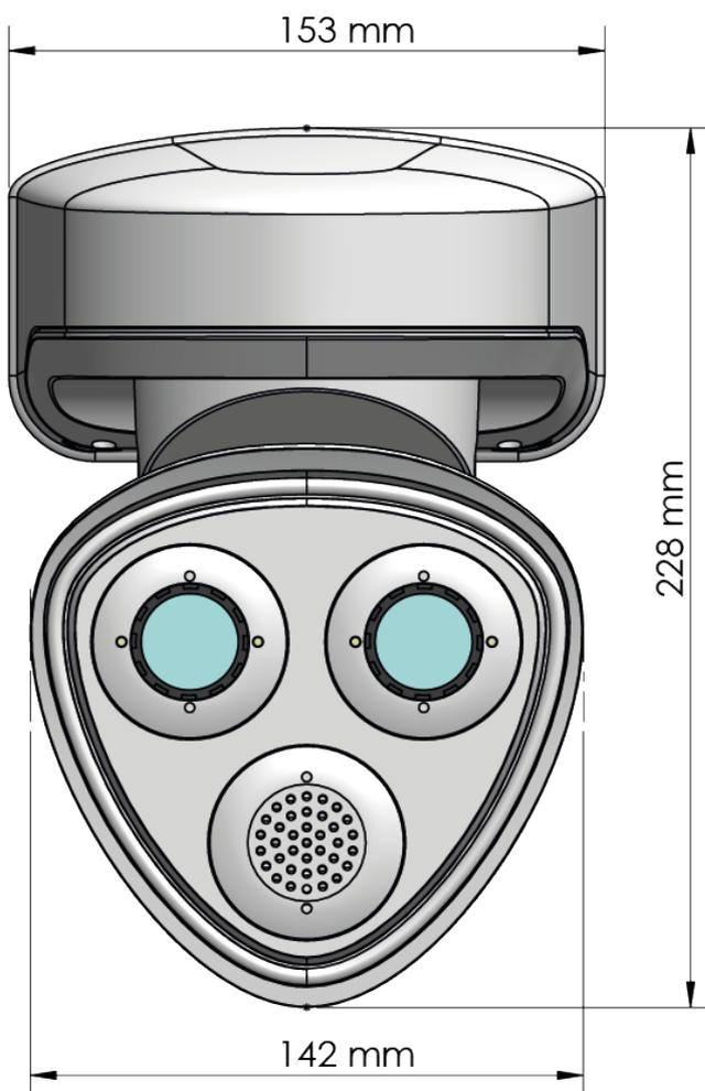
Fig. 4: Abmessungen M73- Frontansicht
