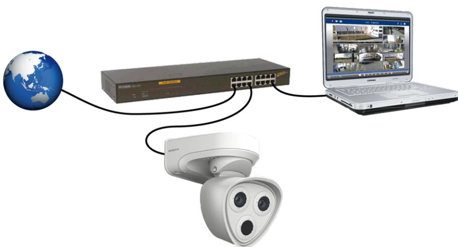
Fig. 19: Spannungsversorgung mit PoE-Switch nach PoE Plus (802.3at-2009)
