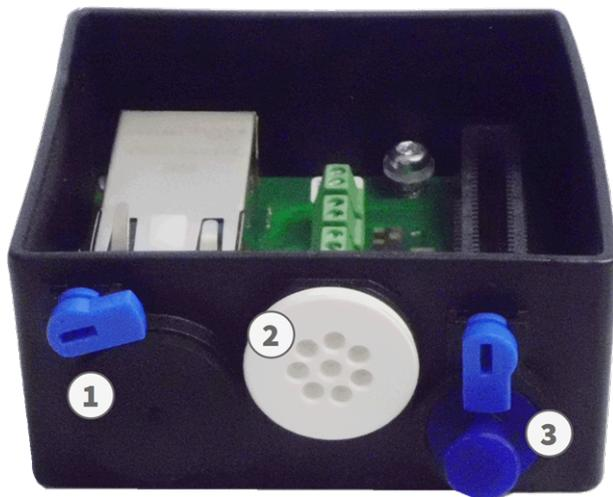
Fig. 20: Anschlussbox mit Gummistopfen Ethernet C.3 (1), Gummistopfen Einzelladern C.4 (2), USB-Stopfen (3) und zwei blauen Verriegelungsstücken
