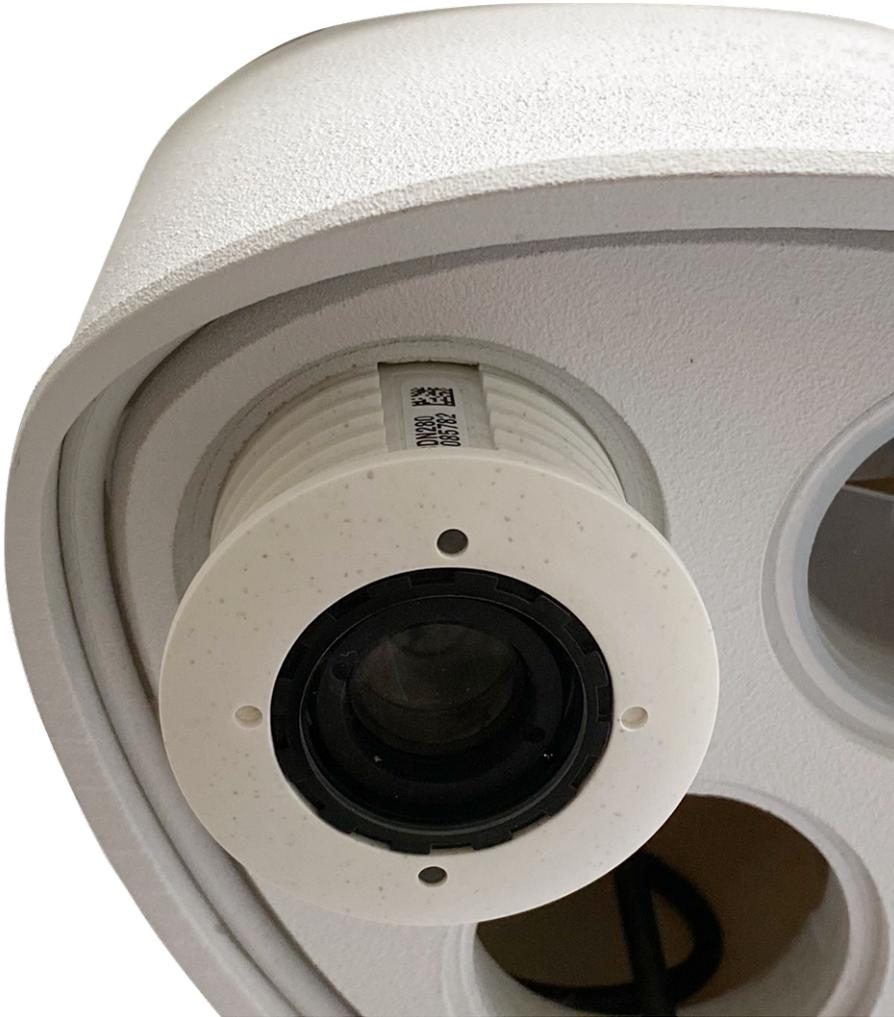
Fig. 12: Sensormodul ins Modulgehäuse einstecken
