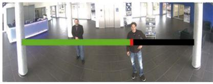
Drehen Sie das Objektiv mit der Hand (evtl. mit einem Tuch, siehe unten Sicherheitshinweis "Objektive nicht berühren") vorsichtig hin und her, bis der rote Bereich der Scharfstellhilfe möglichst vollständig verschwunden ist.
