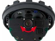
**Hinweis:** Durch den Linseneffekt der Domkuppel verändert sich der Scharfstellpunkt des Teleobjektivs B237 leicht. Drehen Sie daher das Teleobjektiv (vor Montage der Domkuppel) um ca. 90° gegen den Uhrzeigersinn (gegen die Objektiv-Einschraubrichtung). Kontrollieren Sie die Bildscharfe des Kamerabildes bei montierter Domkuppel und korrigieren Sie gegebenenfalls die Scharfstellung.
