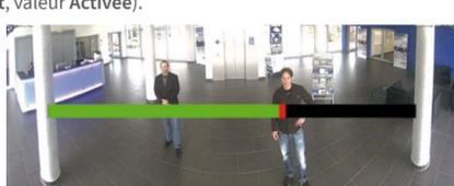
Faites pivoter doucement l'objectif d'un côté puis de l'autre avec la main (éventuellement avec un tissu, cf. les consignes de sécurité « Ne pas toucher l'objectif »), jusqu'à ce que la zone rouge de l'aide à la mise au point ait disparu autant que possible.
