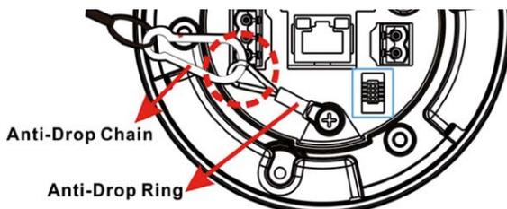
**REMARQUE :** pour des raisons de sécurité, il est recommandé d'attacher la caméra au maillon anti-chute de la retenue lors de son installation. Pour plus d'informations sur le maillon anti-chute et la retenue, contactez le fabricant de la caméra.
