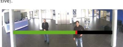
Faites pivoter doucement l'objectif d'un côté puis de l'autre avec la clé d'objectif rouge, jusqu'à ce que la zone rouge de l'aide à la mise au point affichée dans l'image en direct de la caméra ait disparu autant que possible.
