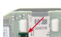
Enfoncez la platine du module dans son logement avec précaution avec votre doigt. Vérifiez que le Mx-A-IOA-IC est complètement enfoncé.
