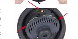
desserrer les vis de fixation (voir ci-dessous) et faire pivoter le support de la platine. Posez les vis avec les rondelles et serrez-les.
