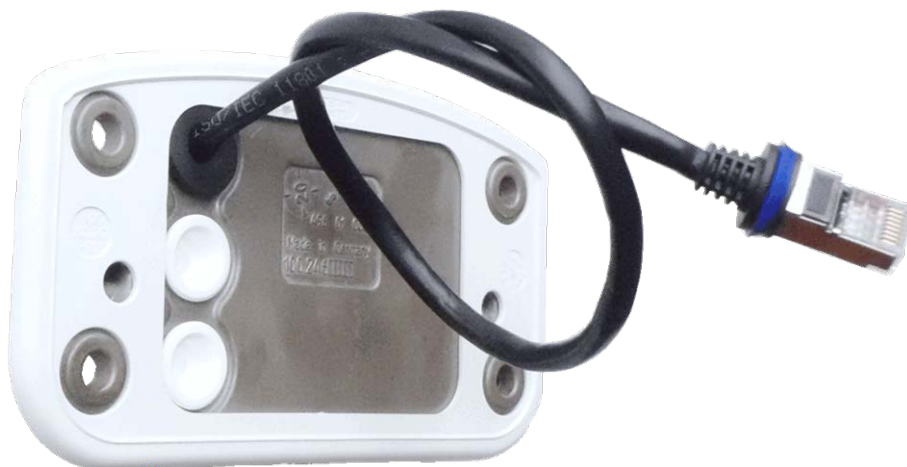
Fig. 21: Connexion réseau du M73
