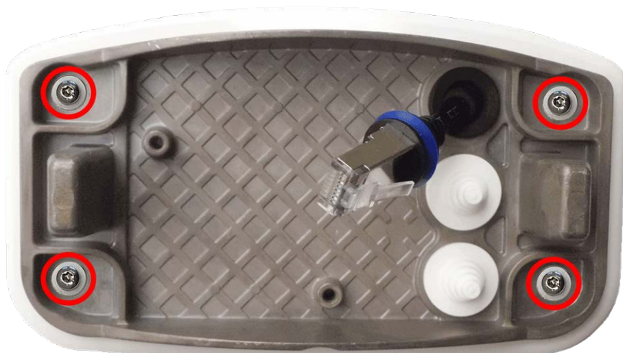
Fig. 23: Plaque d'installation fixée au mur
