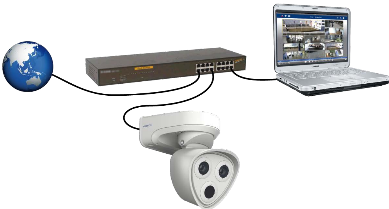
Fig. 24: Alimentation utilisant un commutateur PoE conformément au PoE Plus (802.3at-2009)
