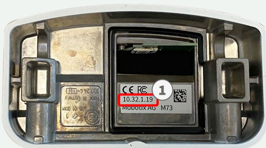
Fig. 5: Adresse IP à l'arrière du boîtier de la caméra
