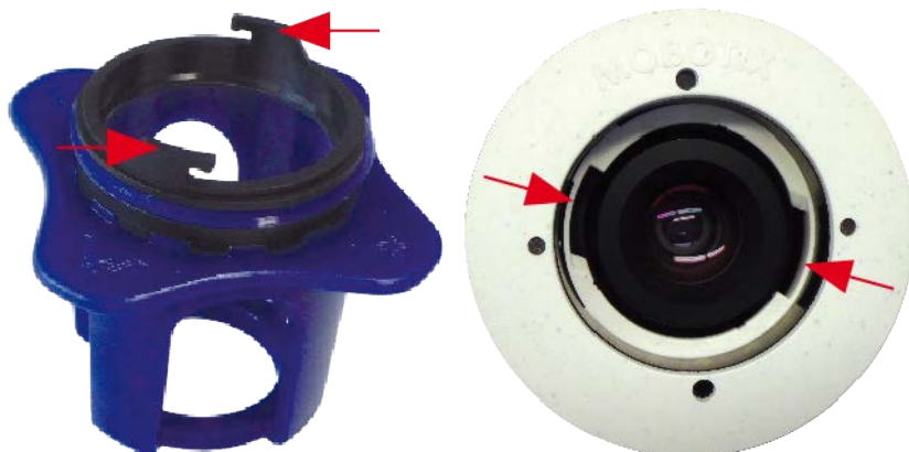
Fig. 44: Insérer le verre de protection de l'objectif à l'aide de la clé à objectif
