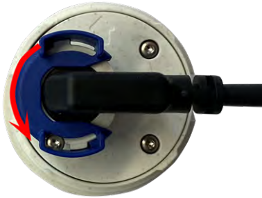
Abb. 22: Unock sensor module
