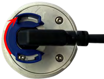
Abb. 9: Lock sensor module
