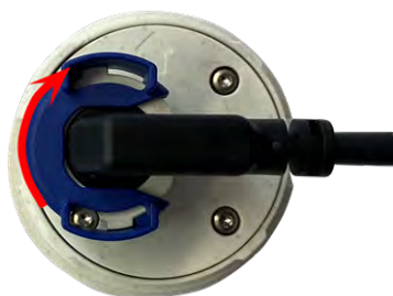
Abb. 28: Lock sensor module
