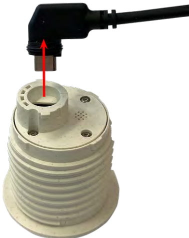
Abb. 23: Remove the sensor module cable
