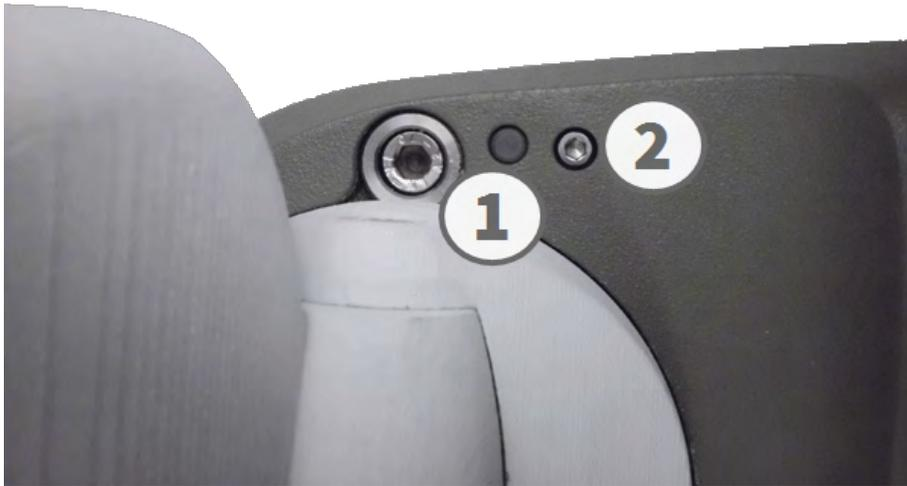
**Abb. 34:** M73 vu du dessous avec LED (1) et vis avec joint (2) cachant la touche qui se trouve à l'intérieur du boîtier de la caméra
