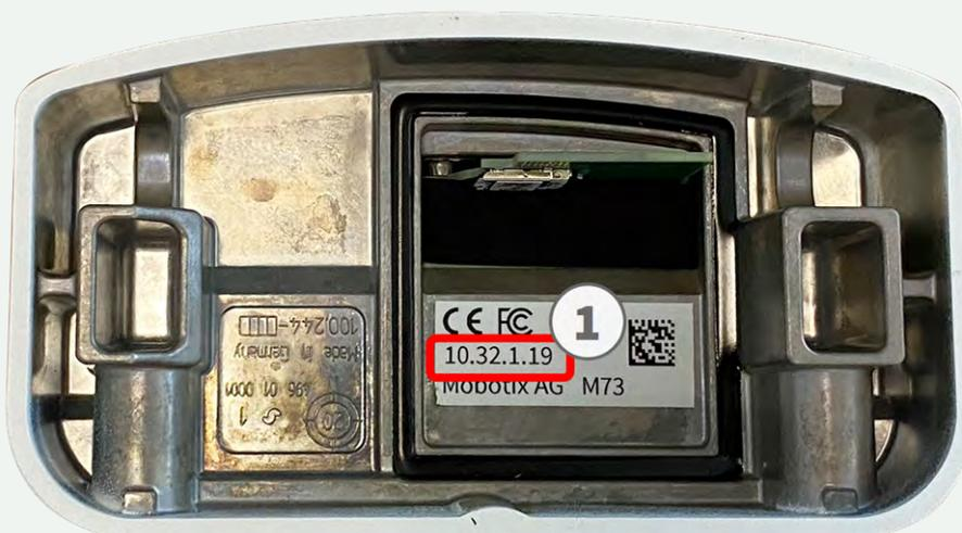
Abb. 5: Adresse IP à l'arrière du boîtier de la caméra
