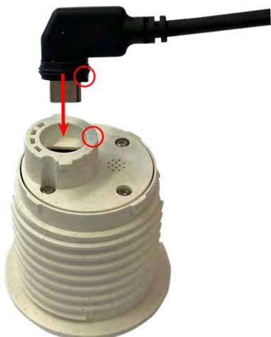
Abb. 8: Connexion du câble du module de détection
