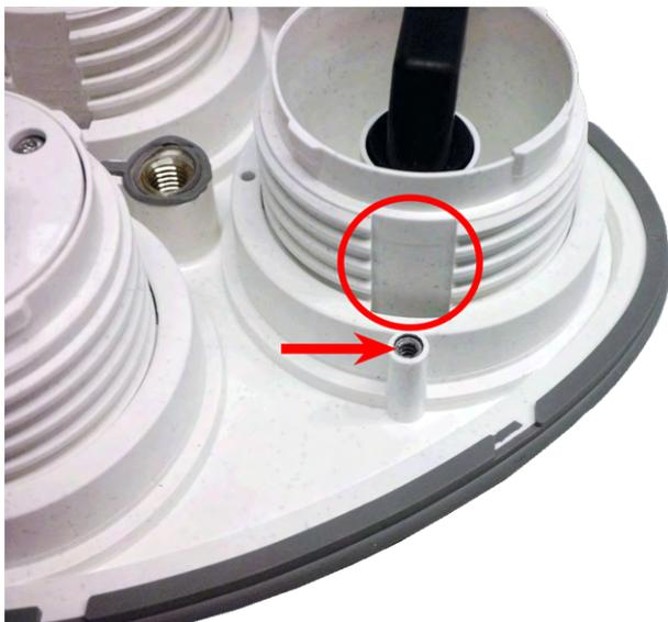
Abb. 15: Rainure pour insérer les clips de sécurité ; trou d'alésage pour vis à tête ovale indiqué par une flèche rouge
