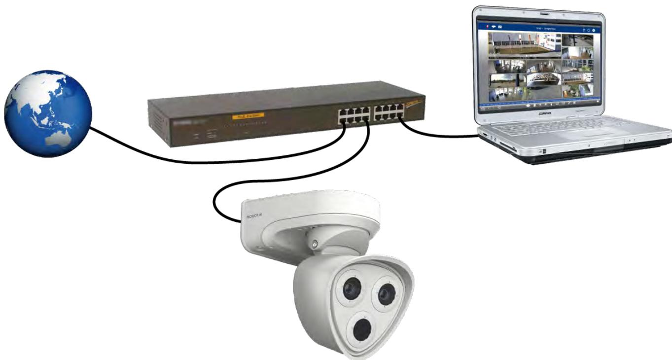
Abb. 24: Alimentation utilisant un commutateur PoE conformément au PoE Plus (802.3at-2009)
