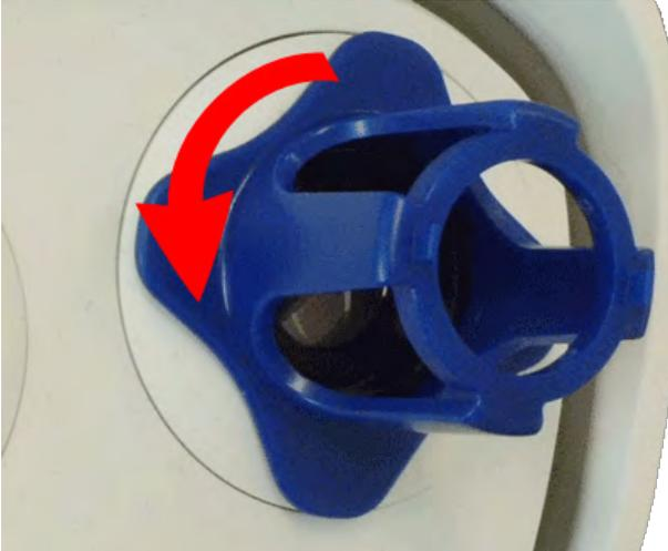
**Abb. 43:** Faites pivoter le module de détection dans le sens inverse des aiguilles d'une montre jusqu'à rencontrer une résistance
